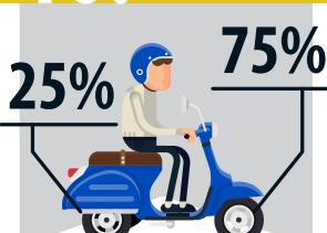
Σε περίπτωση φρεναρίσματος, το μπροστινό φρένο συμμετέχει στο 75% της δύναμης φρεναρίσματος, για αυτό φροντίστε να το ενεργοποιείτε σε κάθε περίπτωση πέδησης. Αποφεύγετε να φρενάρετε σε στροφή. Αν χρειαστεί να φρενάρετε απότομα, τότε φέρτε τη μηχανή σε όρθια θέση και πιέστε δυνατά και τα δύο φρένα.
